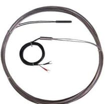
大正仪表公司自主研发的由单芯铠装热电极电缆构成的单芯铠装热电偶，曾被评为重庆市重点新产品、国家火炬计划项目。该产品套管内只设计一根偶芯，正负极彼此具有独立的绝缘铠装套管结构，并根据各自的热电特性数据实现择优组合配对，测温精度高、可靠性高、成品率高、加工容易、方便重复利用。被广泛应用于航空航天和大型装备制造企业。
